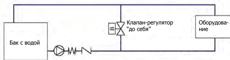
Установка клапана-регулятора «до себя» допускает большой расход, а также стабилизирует давление в трубопроводе.
